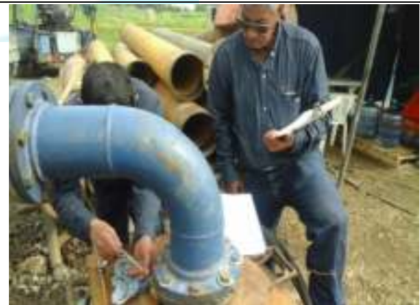
TOMA DE REGISTROS DE RECUPERACIÓN DEL POZO PRINCIPAL UNA VEZ TERMINADA LA PRUEBA DE BOMBEO 35 LPS. 15/SEP/2018
